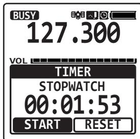
6. Zum Löschen der Zählung "RESET" auf dem Display durch Drücken von [◀] oder [▶] auswählen, und dann die [ENT]-Taste drücken.
