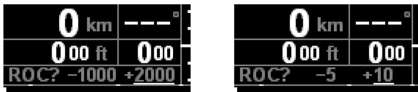
Je nach eingestellter Maßeinheit kann hier als Vario-Vollausschlag (zweite Markierung) zwischen  $\pm 1000$  ft/min bzw.  $\pm 5$  m/s und  $\pm 2000$  ft/min bzw.  $\pm 10$  m/s gewählt werden.
